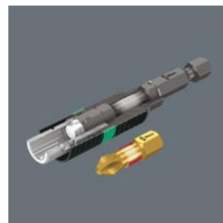
Die optimal abgestimmten Kennlinien der Torsionszonen von Bit und Halter ermöglichen ein abgestuftes Nachgeben bei Belastung. Das zweistufige System verhindert frühzeitigen Verschleiß. Darüber hinaus ist ein langes Werkzeugeleben auch durch die auf die jeweilige Anwendung ausgelegte Härte der Bits garantiert.
