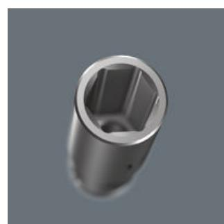
Das Sechskantprofil ermöglicht die Übertragung hoher Kräfte und belastet die Kanten der Schraubenmutter bzw. des Schraubenkopfes weniger als ein Zwölfkantprofil. Feinverzahnte Knarren machen darüber hinaus durch ihren kleinen Rückschwenkwinkel den Einsatz eines Zwölfkantprofils auch in begrenzten Raumverhältnissen überflüssig.
