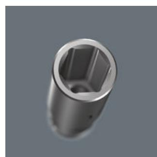
Das Sechskantprofil ermöglicht die Übertragung hoher Kräfte und belastet die Kanten der Schraubenmutter bzw. des Schraubenkopfes weniger als ein Zwölfkantprofil. Feinverzahnte Knarren machen darüber hinaus durch ihren kleinen Rückschenkwinkel den Einsatz eines Zwölfkantprofils auch in begrenzten Raumverhältnissen überflüssig.
