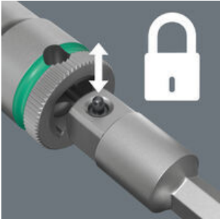
Die federnde Kugel auf dem Vierkant greift in die Bohrung des Steckschlüsseinsatzes und sichert so den Stückschlüsseinsatz auf dem Verbindungsteil.
