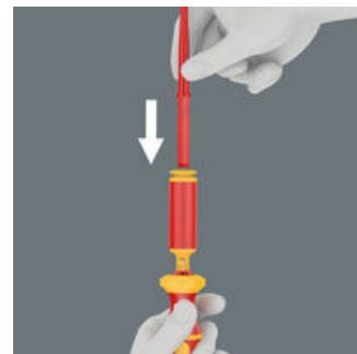
Je nach Arbeitsanforderung wird die isolierte Wechselklinge mit dem benötigten Abtriebsprofil oder ein Schaltschankschlüssel in die Aufnahme des Griffes geführt.
