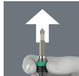
Zum Bitwechsel einfach die Hülse nach vorne schieben: Dabei hebt der Federmechanismus den Bit vom Magneten ab und entriegelt das Werkzeug. Der Bit kann problemlos entnommen werden. Besonders hilfreich: Mühelose Entnahme auch kleinsten Bitgrößen ohne Hilfswerkzeug.
